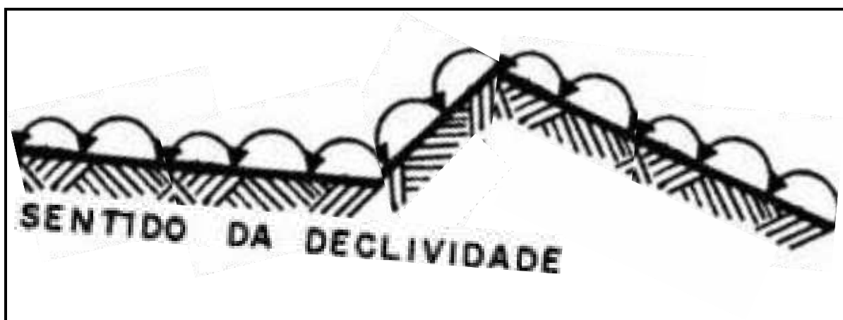
Figura 22 - Perfil da barreira de contenção da erosão.
