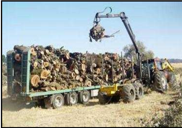
Figura 41 - Descarregamento em Carreta Rodoviária de Trator Autocarregável.
