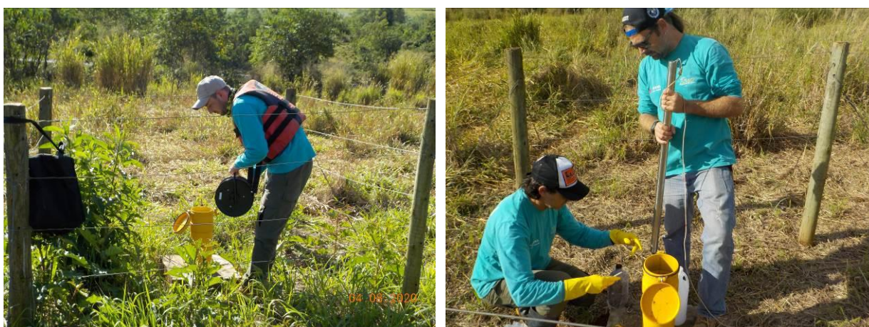
Figura 4-10 Procedimentos de medição de profundidade do lençol freático e de coleta da água
