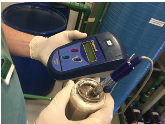
Análise da qualidade da água tratada na ETA da casa de força.
