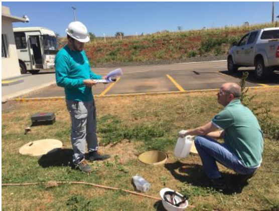
Amostragem do efluente do sumidouro da guarita.
