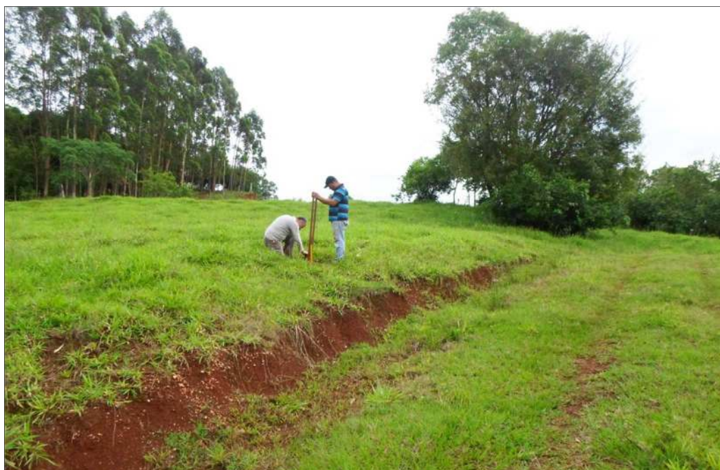
Figura 36 - Abertura de sondagens por cavadeiras manuais.
