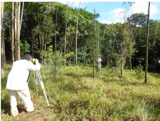
A partir do ponto zero, com a utilização de nível óptico, delimitação dos setores.
