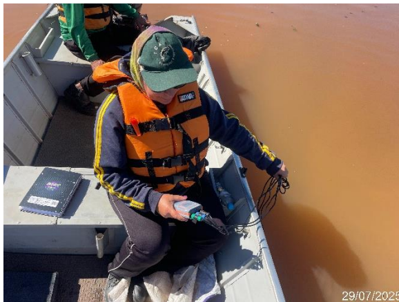
Figura 25. Aferição de parâmetros abióticos da água com sonda multi-parâmetros, julho de 2025.
