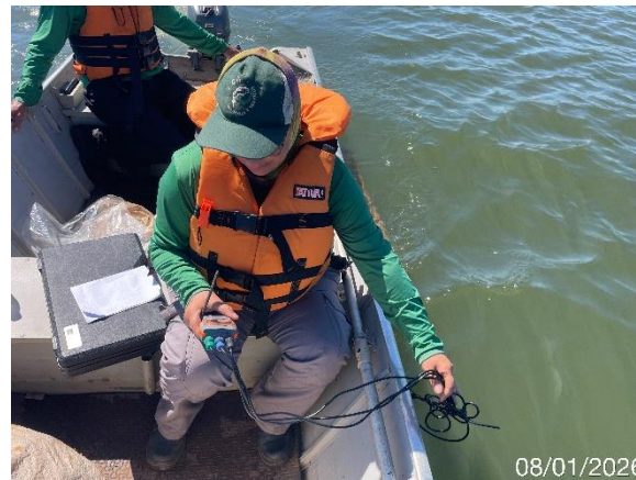
Figura 26. Aferição de parâmetros abióticos da água com sonda multi-parâmetros, janeiro de 2026.
